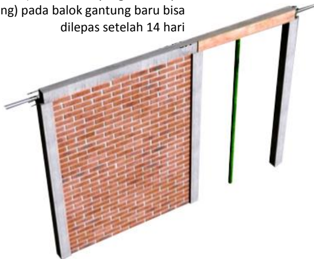
Gambar 61. Pelepasan Cetakan/ Bekisting
