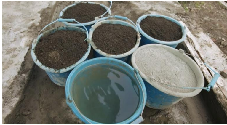
Gambar 7. Bahan Campuran Mortar
