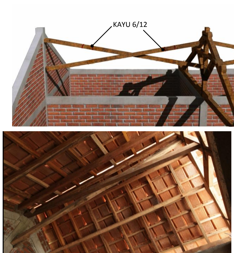
Gambar 36. Ikatan Angin Antara Kuda-Kuda Kayu dengan Gunung-Gunung/ Ampig
