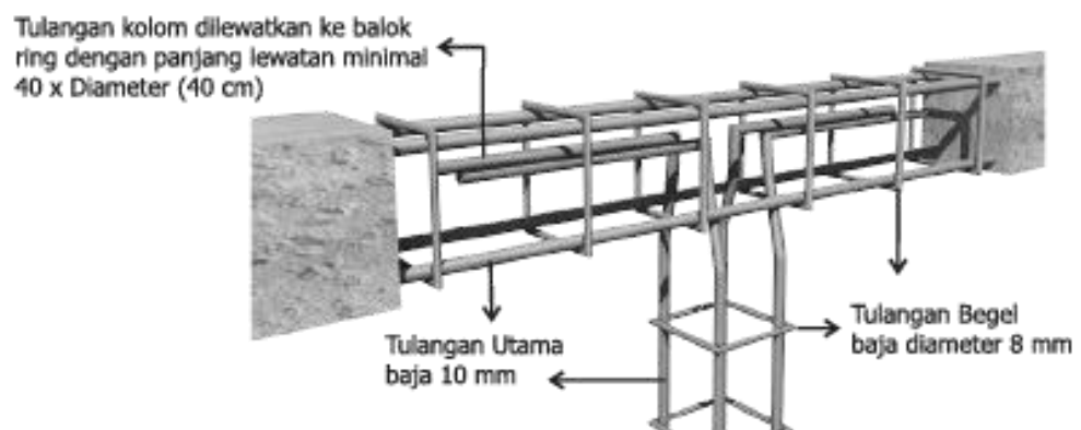
Gambar 48. Hubungan Anatar Kolom dengan Balok Keliling/ Ring
