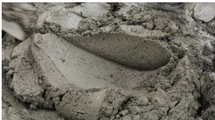
Gambar 9. Hasil Pencampuran Mortar Yang Baik
