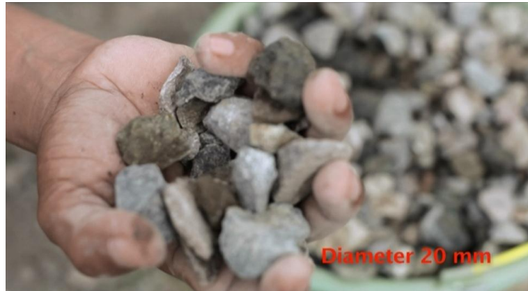
Gambar 5. Diameter Kerikil Yang Baik Untuk Campuran Beton
