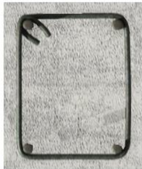
Tebal selimut beton 1 cm
