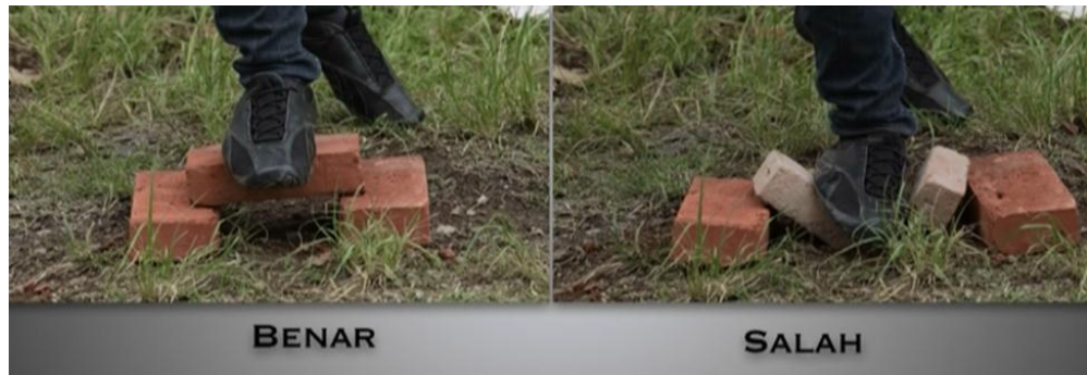
Gambar 13. Pengujian Sederhana Kekuatan Batu Bata
