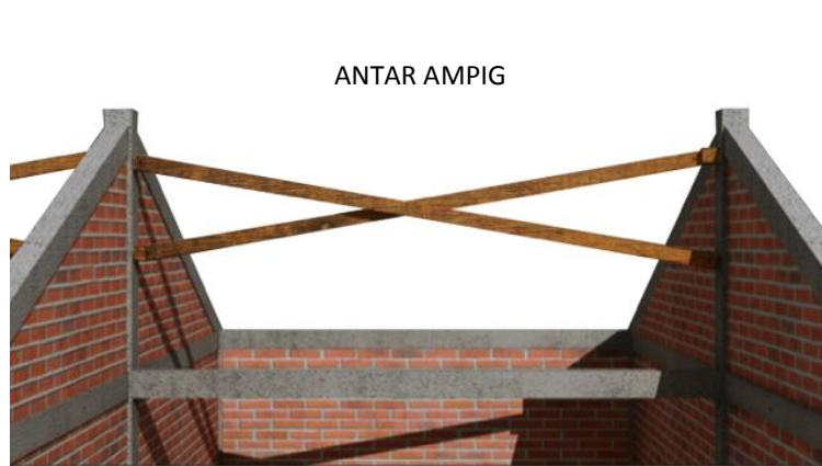
Gambar 35. Ikatan Angin Sebagai Pengikat Antar Gunung-Gunung/ Ampig
